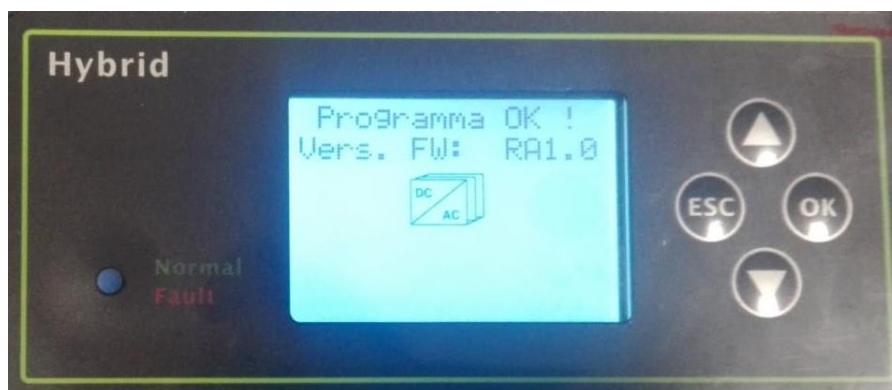
Foto del display di un sistema storage al termine dell'aggiornamento, prima di tornare in standby.
